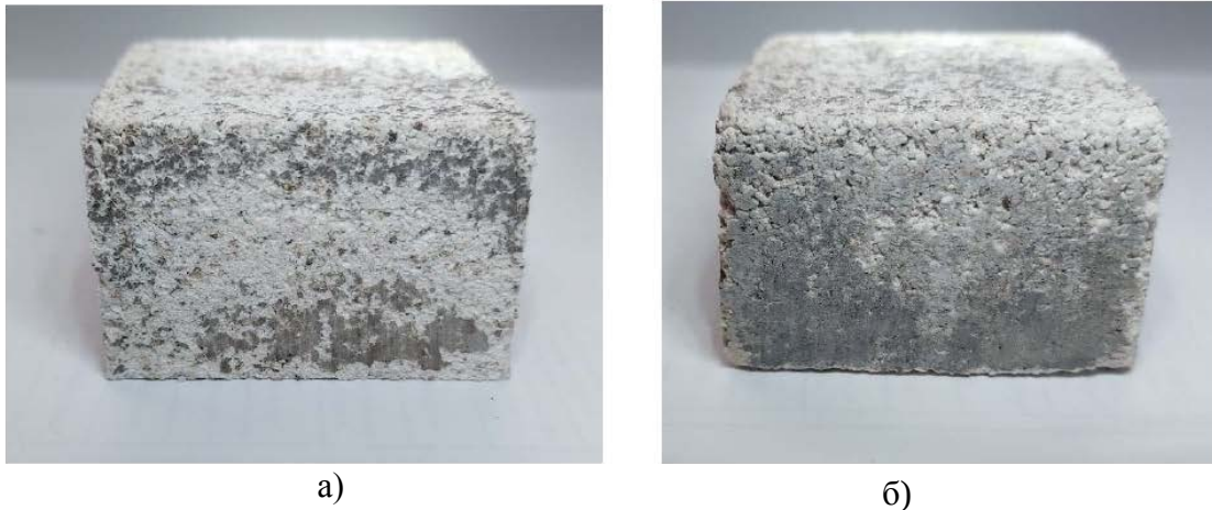
Рис.1 – Порівняння зовнішнього вигляду зразків термоперліту після випробувань на довговічність: а) до випробувань; б) після випробувань
